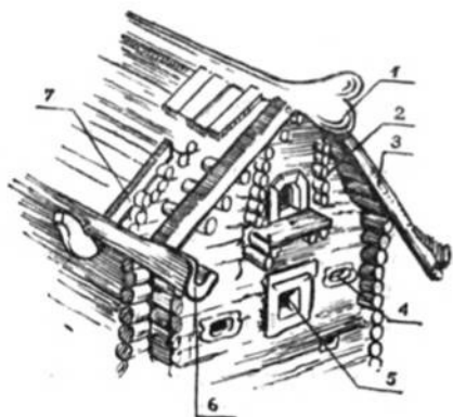
Схема наименований деталей конструкции русской избы, построенной без применения гвоздей: (1) охлупель, (2) слезги, (3) причелина, (4) волоковое окно, (5) красное окно, (6) водоточник, (7) курица.
